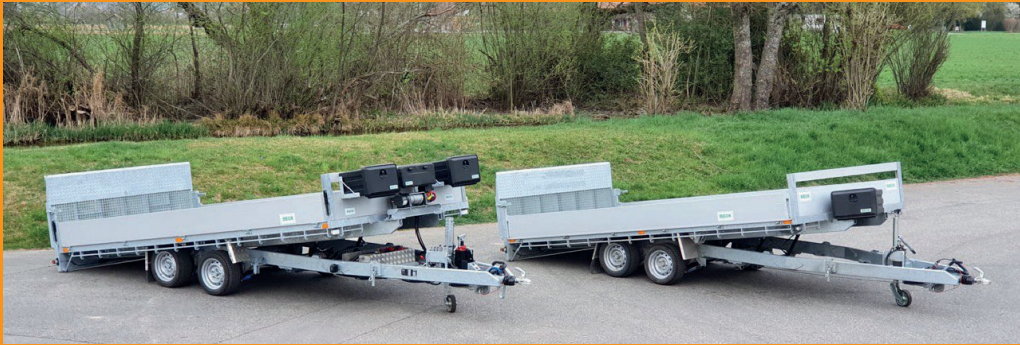
„Becky 30“ und „Becky 35“ - 3.0 / 3.5 To. - 430 / 450 x 210 / 230 cm mit hydr. Heckabsenkung (mech. / elektro) / abaissement hydraulique de l'arrière
